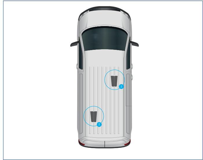
Montieren sie den Easy Aero im Falle eines einzigen Ventilators so weit wie möglich in der Mitte des Daches, gemessen ab dem Zwischenschott bis zur hinteren Klappe oder den hinteren Türen.
