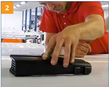
Bringen Sie die Schaumdichtung an der Unterseite des Easy Aero an und stecken Sie die Rohre durch die Löcher mit dem Gitter an der Vorderseite. Die Schaumdichtung ist separat in verschiedenen Dicken erhältlich. Fragen Sie unsere Spezialisten nach der empfohlenen Dicke. **Hinweis: Es muss immer Schaumdichtung angebracht werden!**
