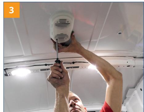
Schrauben Sie die Abdeckplatte mit den mitgelieferten Schrauben an der Innenseite des Daches fest. Der Dachventilator wurde montiert: easy!
